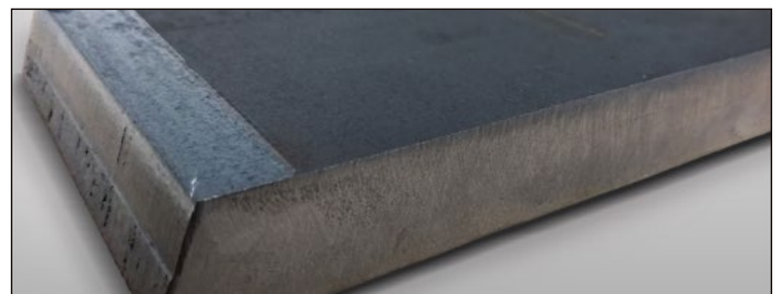
Czyszczenie krawędzi, przygotowanie do spawania
